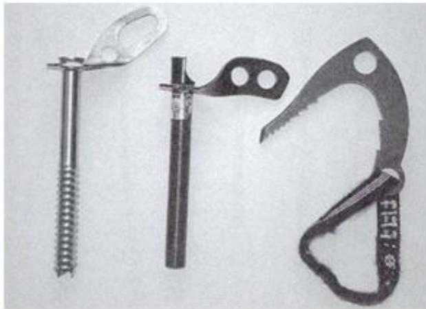
Figura 12. Tornillo tubular, pitón de percusión y gancho.
